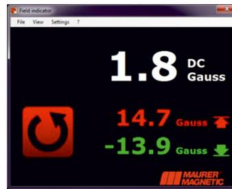
Hauptfenster mit dem aktuellen Messwert sowie dem Maximalwert vom Nord- und Südpol
