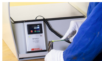
Mesure du magnétisme résiduel du même couteau dans le champ magnétique terrestre. Les champs induits falsifient le résultat de la mesure de 0,1 \text{ A/cm} à environ 2,1 \text{ A/cm}
