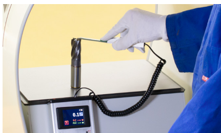
Mesure du magnétisme résiduel d'une fraise dans la chambre de Gauss zéro. La fraise démagnétisée a un magnétisme résiduel de 0,1 \text{ A/cm} .
