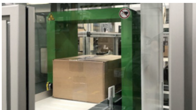
Impulsion de démagnétisation active pour la démagnétisation d'une caisse de produit en vrac
