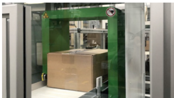
Aktiver Entmagnetisierpuls für das Entmagnetisieren einer Kiste mit Schüttgut
