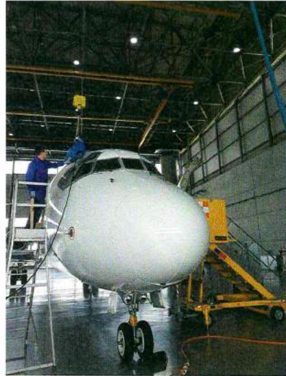
Entmagnetisieren der Edelstahlrahmen von durch Blitzschlag magnetisierten Cockpitfenstern.
